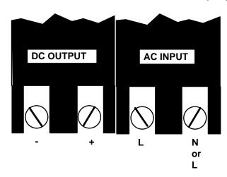
277, 380, 415 OR 480 VAC MAKE INPUT & OUTPUT CONNECTIONS DIRECT TO CIRCUIT BREAKERS AS SHOWN.
